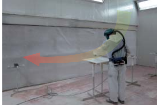
RYCINA 1. Wysokociśnieniowe napyłanie w kabine lakierniczej. Przepływ powietrza w układzie wentylacyjnym zaznaczono strzałką; kolor zielony oznacza niską liczbę nanocząstek, zaś kolor czerwony oznacza wysoką liczbę nanocząstek.
