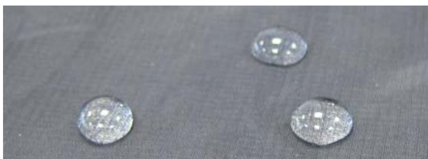
Tkanina nylonowa pokryta wodoodporną, łatwą w czyszczeniu powłoką na bazie ciekłego szkła.
