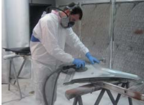
RYCINA 3. Dwa przykłady środków kontroli narażenia mających zapobiec narażeniu na MNM podczas szlifowania lub polerowania materiałów zawierających MNM.
