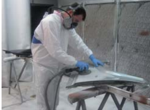
ФИГУРА 3. Два примера за мерки за контрол на излагането за предотвратяване на излагането на MNM при шлайфане или полиране на съдържащи MNM материали. Вляво: цех с вакуумна вентилация; вдясно: оптимална защита с нитрилни ръкавици, костюм Tyvek и респираторна маска с FFP3 филтър.
