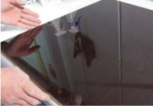
Superficie levigata di un pannello MDF con uno strato superiore di bambù trattato con lacca antigraffio a base di Nano-SiO 2 .
