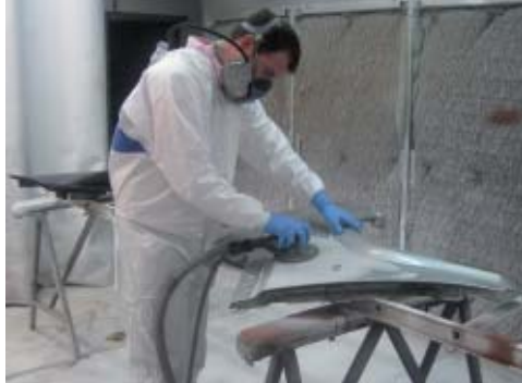
FIGURA 3. Două exemple de măsuri de control a expunerii pentru a se preveni expunerea la MNM în timpul sablării sau șlefuirii materialelor ce conțin MNM. Stânga: un banc de lucru cu ventilare a gazelor prin vacuum; dreapta: protecție optimă cu ajutorul mănușilor de nitril, un costum Tyvek și mască respiratorie cu filtru FFP3.
