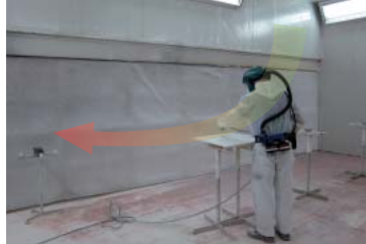
FIGURA 1. Pulverizare la presiune ridicată în cabina de pulverizare. Circuitul aerului din sistemul de ventilație este reprezentat printr-o săgeată: verde indică un număr scăzut de nanoparticule, roșu indică un număr ridicat de nanoparticule.
