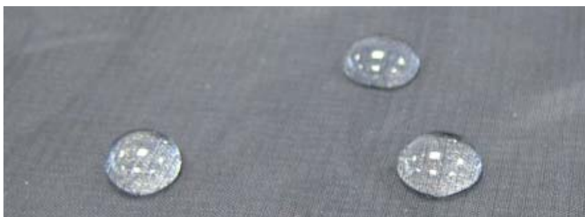
Țesăturile din nailon tratate cu acoperire impermeabilă, ușor de curățat pe bază de sticlă lichidă.
