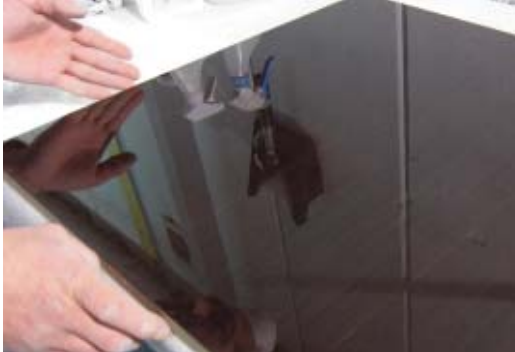
Suprafață șlefuită a unui panel MDF cu strat superior din bambus, tratat cu lac cu rezistență mare la zgâriere pe bază de Nano-SiO 2 .
