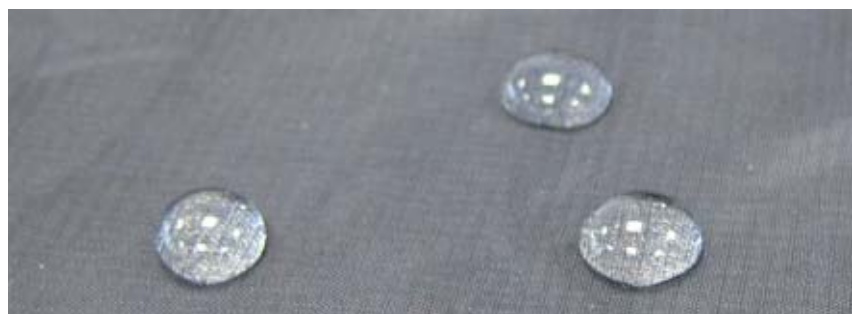
Mit einem Wasser abstoßenden Mittel behandeltes Nylongewebe. Leicht zu reinigender Beschichtungstoff mit Flüssigglas.
