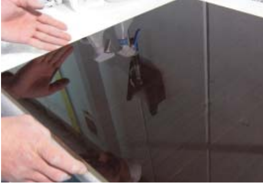
Polierte Oberfläche einer MDF-Platte mit einer Oberschicht aus Bambus, mit einem besonders kratzerfesten Lack mit Nano-SiO 2 behandelt.
