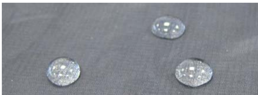
Met een waterafstotend middel behandeld nylonweefsel. Gemakkelijk te reinigen coating gebaseerd op vloeibaar glas.
