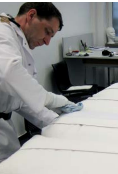
FOTO 2. Coaten van het kussen van een tandartsstoel met een pompverstuiver en een zachte wrijfdoek.
