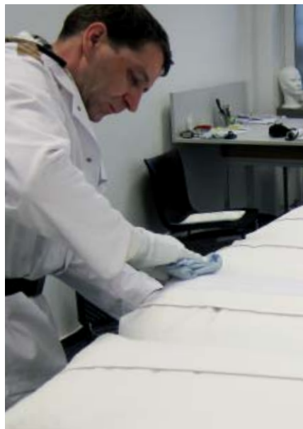
FIGURA 2. Revestimiento de un cojín para el sillón de un dentista con un pulverizador de bomba y un paño suave de limpieza.
