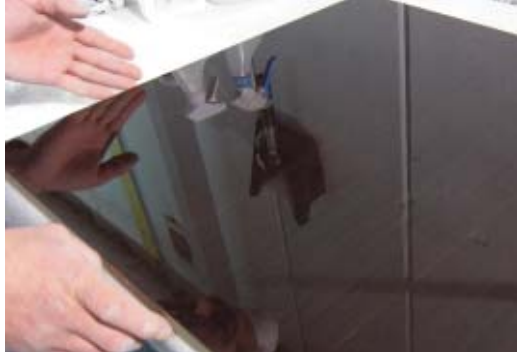
Superficie pulida de un tablero de fibra de densidad media con una capa superior de bambú, tratada con una laca altamente resistente a los arañazos y basada en nano-SiO 2 .
