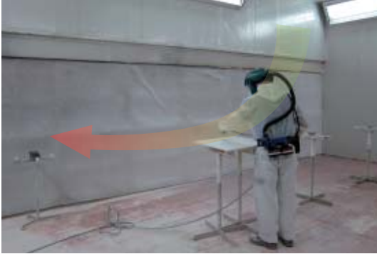
FIGURA 1. Pulverización a alta presión en la cabina de rociado. El flujo de aire del sistema de ventilación está representado por la flecha: el color verde indica un reducido número de nanopartículas y el rojo indica un elevado número de nanopartículas.
